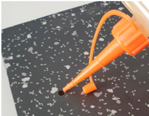
Schutz einer Bohrung mit Delignit® WaterProtect
